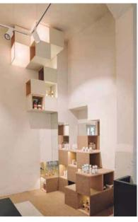
El elemento protagonista del local es un cubo de madera de 40 x40 cm, abierto por dos de sus caras que permite su repetición y apilamiento, creando un sistema de llenos y vacíos. Una estructura que se apoya en las paredes y techo del local funcionando como exhibición en sus vacíos, almacenamiento en sus llenos e iluminación en las zonas superiores.
